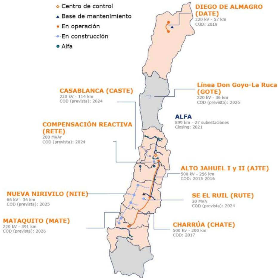
Ilustración 2: Transporte de energía eléctrica de Celeo en Chile
